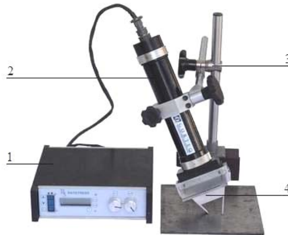
Fig. 4. RAYSTRESS: Equipamento portátil de raios-X para medição de tensões mecânicas
