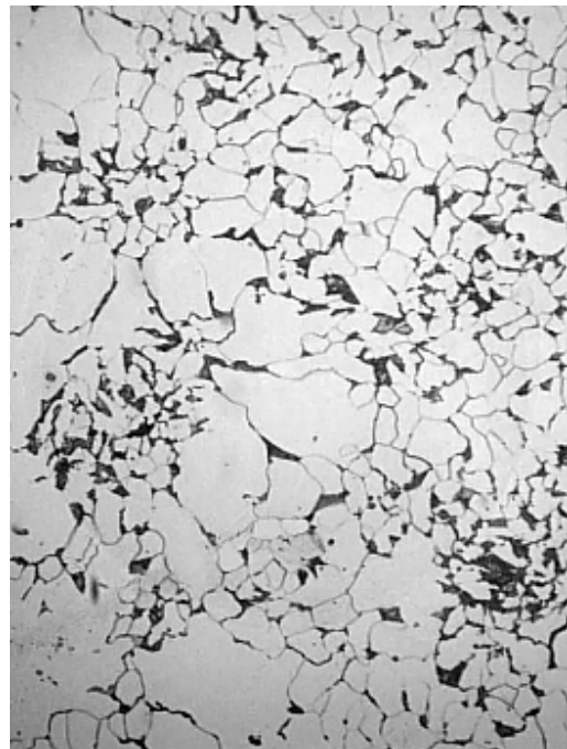
Fig. 24. Microestrutura da ZTA. (A) – Solda com eletrodo simples. (B) – Solda com eletrodo duplo. Amplificação original x100
